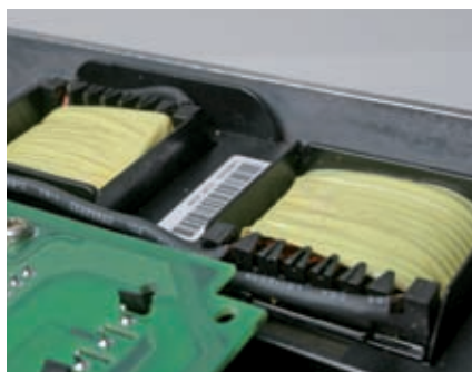
L'inverter integra i filtri RFI per la conformità alla EN55011 (A2, A1 e B1) e le bobine DC nel circuito intermedio per la riduzione del contenuto armonico generato.
