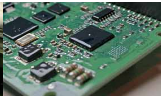
Sono disponibili schede di controllo trattate per l'utilizzo dell'inverter in ambienti aggressivi.
